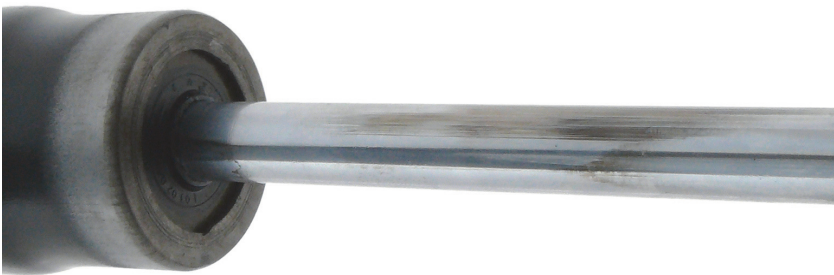
Abb. 2: Chromschicht der Kolbenstange durch verspannten Einbau einseitig abgenutzt
