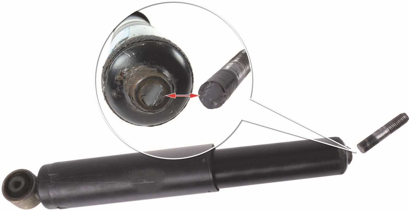
Abb. 1: Stiftgelenk durch wechselnde Biegebelastung gebrochen.
