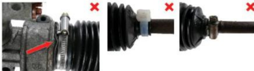
Abb. 4/5/6: Bypass / Mangelhaft abgedichtete Lenkmanschetten.
