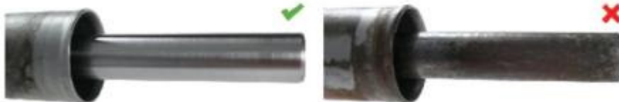
Abb. 2: Zahnstange ohne Korrosion
