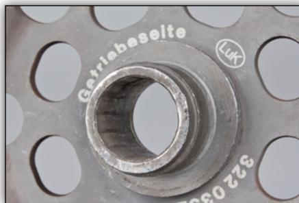
**Bild 2:** beschädigtes Nabenprofil
