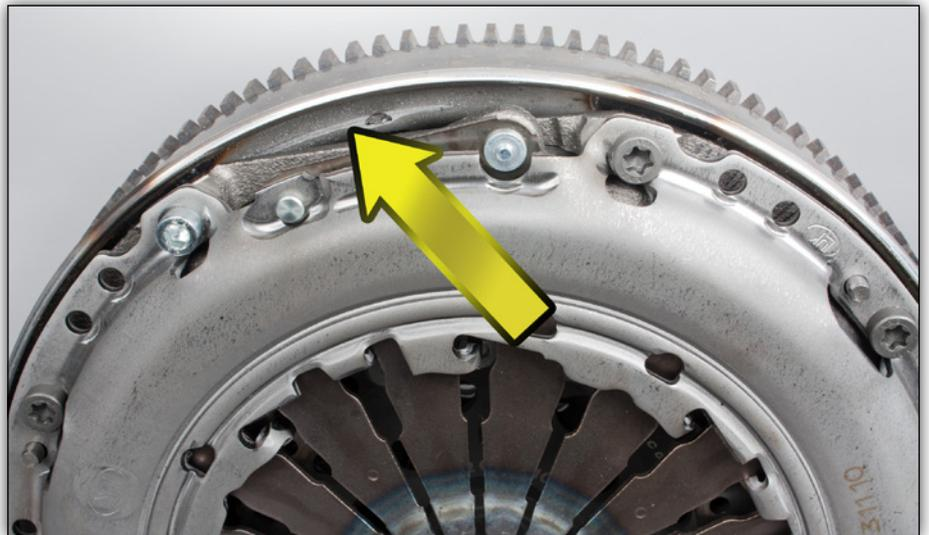
**Bild 1:** Materialabtrag bei Verwendung einer zu langen Schraube
